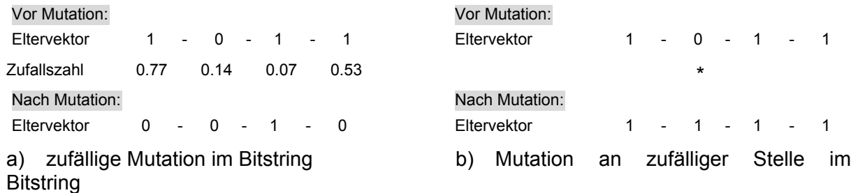
Bild 2: Mutation bei Genetischen Algorithmen
