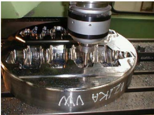
**Figure 2. Milling of a die cavity**
