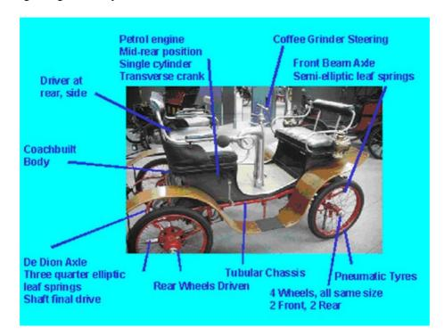
Figure 1: 1901 de Dion vis à vis showing layout parameters
